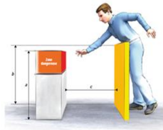
Protecteur fixe qui interdit l'accès à la zone dangereuse de toutes parts
