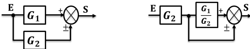
Figure III.5 : Retrait d'un élément d'une chaîne d'action
